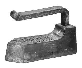
Bügeleisen. Eisenkörper, lange parallele Form mit eisernem Griff. Firmenstempel: F. Bender, Zürich. Grössenmarke: 4. MR 2586. Länge 19 cm. 2. Hälfte 19. Jahrhundert. Schenkung. Industriemässig hergestelltes Bügeleisen, das nicht für den Haushalt bestimmt war. Solche Eisen wurden in Fabrikationsbetrieben (Textilindustrie) oder in Werkstätten verwendet.
