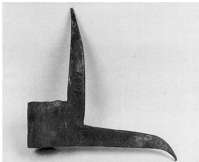
Feuerhaken zum Abstützen oder Rausreissen, an ca. 8 m langem Stiel.
