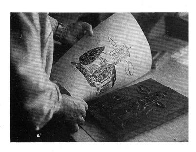
Hier der exakt gearbeitete Druckstock mit Druckträger.
