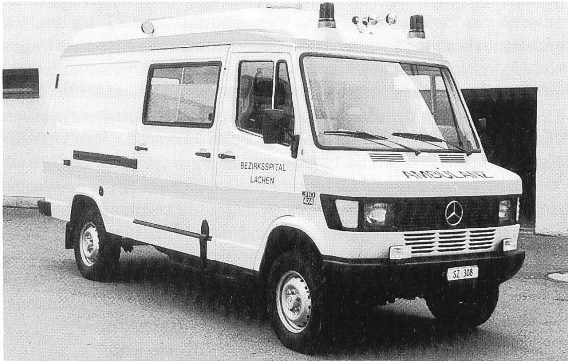
Die moderne Ambulanz für Reanimationseinsätze. Die Ambulanz ist so hoch, damit man stehend am Patienten während der Fahrt arbeiten kann. Vor zwei Jahren stimmte das Volk des Bezirkes March einer Änderung der alten Vorschrift zu, dass die Krankentransportkosten neu von Versicherung oder Patient zu bezahlen seien. (Foto Spital)
