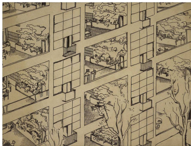
Le Corbusier, projet d'immeuble-villa, 1922, plan de l'étage des villas et axonométrie montrant les jardins suspendus.
