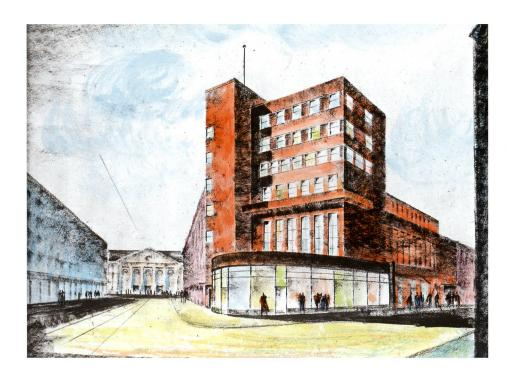
fenêtres ébrasées. Le noyau structurel est une ossature de béton armé, comme le laisse supposer les trois grands portails qui donnent sur la place et la distribution des fenêtres carrées dans la partie haute de la tour. De gros montants angulaires et de hauts sommiers avaient probablement été imaginés, similaires à ceux qu'Adolf Loos avait réalisés pour l'immeuble Goldman et Salatsch à Vienne.
