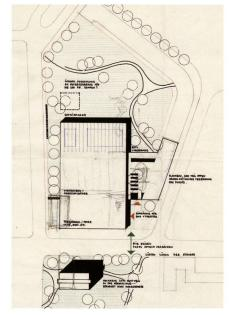
Plan de situation du premier avant-projet, octobre 1956 et variante du premier avant-projet, 1956-1957. Sur ce plan de situation, la tour de bureaux est dessinée sur le site de l'usine à gaz, mais une figure rectangulaire esquissée au crayon démontre que des raisonnements sur le repositionnement de la tour à l'angle des rues Centrale et de l'Argent sont en cours.
