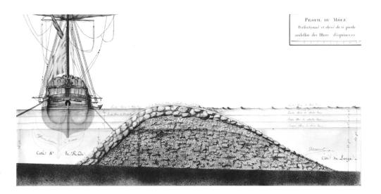
Louis-Alexandre de Cessart, projet de couverture des digues entre les cônes avec une «couche de mortier de beton et pozzolane», AN.
