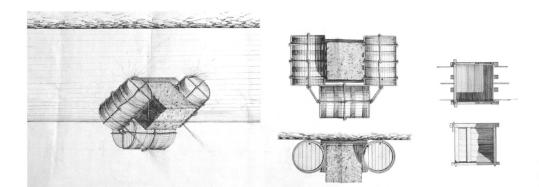
Nicolas Céard, projet du dispositif pour transporter et échouer les blocs de béton, EPetCh, Ms 2568(1), pièce 5.
