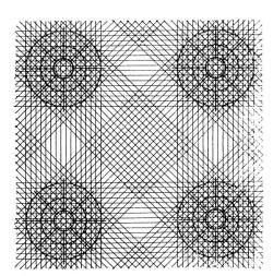
Schéma des armatures dans une dalle-champignon. A gauche le système Maillart et, à droite, le système américain de C.A.P. Turner.
