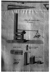
Dessin d'une machine pour le calcul de résistance des matériaux (in Machine pour connaître la force des pierres, in Collection de dessins relatifs à l'art de l'ingénieur, vol. V, manuscrit, Ecole nationale des Ponts et Chaussées, Paris, Ms 206(5), f. 46).
