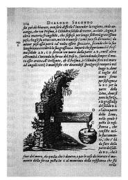
Galileo Galilei, dessin d'une poutre avec une extrémité libre et l'autre encastrée dans un mur (G. Galilei, Discorsi e dimostrazioni matematiche intorno à due nuove scienze attenenti alla Mecanica e i movimenti locali, Leida, 1638, p. 114).
