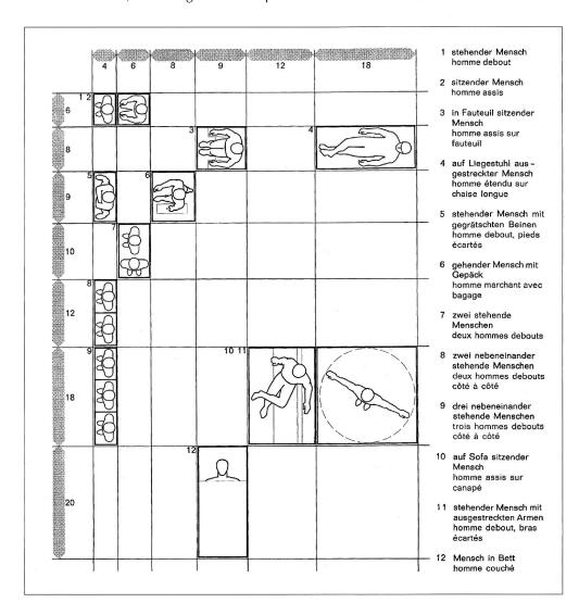
A gauche: Homo ad quadratum, ad rectangulum, ad circulum dans la représentation de grandeurs modulaires fonctionnelles appliquées au dessin et exprimées en modules de 10 cm. (Tiré de Pierre Bussat, Die Modulordnung im Hochbau/La coordination modulaire dans le bâtiment, Karl Krämer Verl., Stuttgart, 1963, p. 31).
