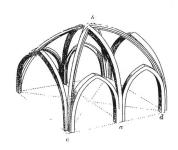
Fig. 2 Le dessin de la disposition des nervures dans une voûte gothique. In Otto Warth, Die Konstruktion in Stein, Bd. 1 de l'Allgemeine Baukonstruktionslehre, begründet von G. A. Brymann, J. M. Gebhardt's Verl., Leipzig, 1903, 17e édition (6e dit., 1896), p. 267.
