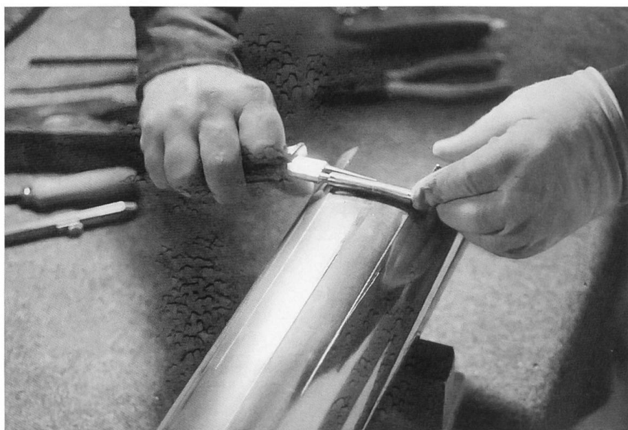
Der Bau einer Orgel erfordert viel Handarbeit, so auch beim Anbringen der sog. Stimmrollen, mit denen die Tonhöhe der Pfeifen reguliert wird (im Bild: Octav-Achtfuss-Pfeife).
