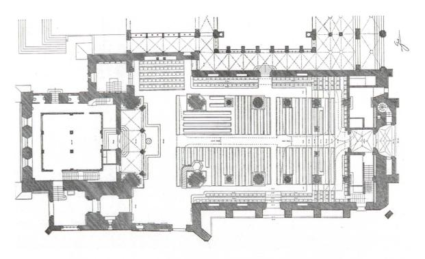
Abb. 4: Gulls Grundriss der Kirche nach der Restaurierung von 1911/12 (Lettner zurückversetzt) zeigt die Anordnung der Einbauten im Chor und den direkten Zugang in den Chorraum aus der Vorhalle. (Plankopie von Zemp, 1914)
