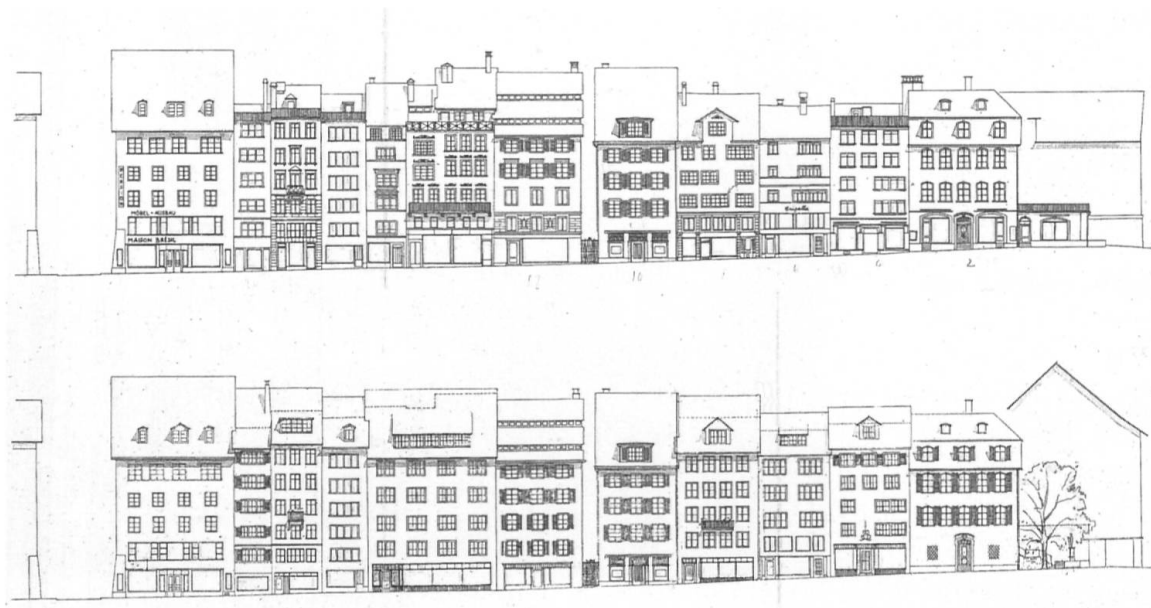
Abb. 128: Hans von Meyenburg, Sanierungsprojekt für die Altstadt, Block 25 (1948). Fassaden am Rennweg, Bestand (oben) und Projekt (unten).
