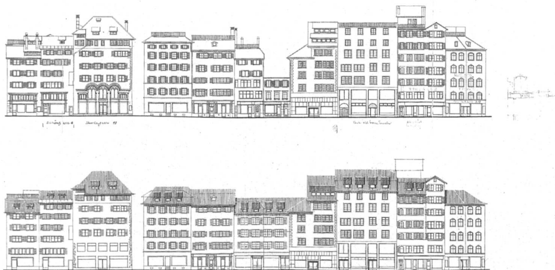
Abb.81: Max Lüthi, Richard F. Zangger, Sanierungsprojekt für die Altstadt, Block 29 (1950). Fassaden an der Storchengasse, Bestand (oben) und Projekt (unten).
