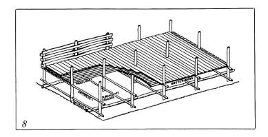
Abb. 7. Le Corbusier. Die zum Zweck der Serienherstellung entwickelte Skelettbauweise *Dom-Ino* (1914/15).
