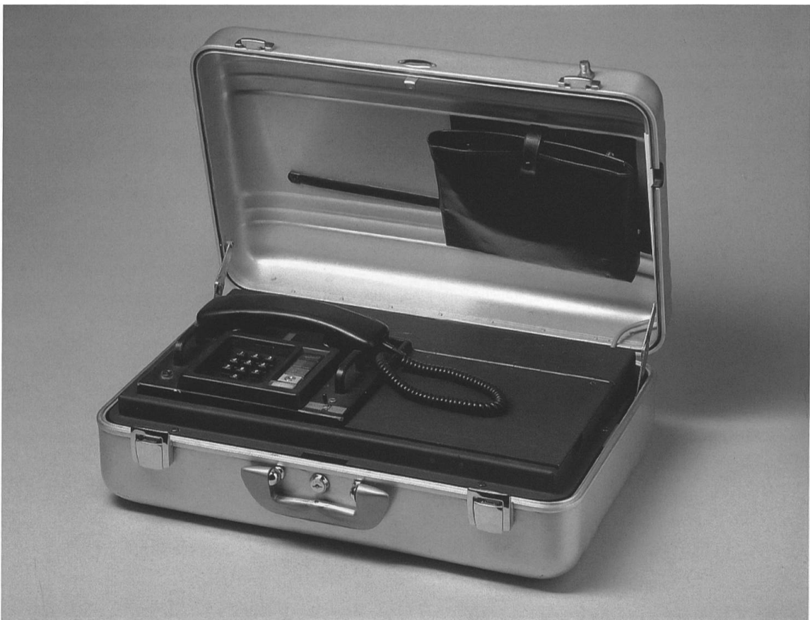
Abb. 12: NATELport, erstes Mobiltelefon der Schweiz der Firma Brown Boveri, 1978, Preis zirka 16'000 Fr., Gewicht 15 kg, Masse 36,5 x 53,5 x 18 cm, LM 80207.
