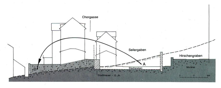
2 Chorgasse: Schnitt durch den mittelalterlichen Wehrbering mit der zugehörigen und der heutigen Topographie. Der Aushub (A) wurde nach B verlagert.
