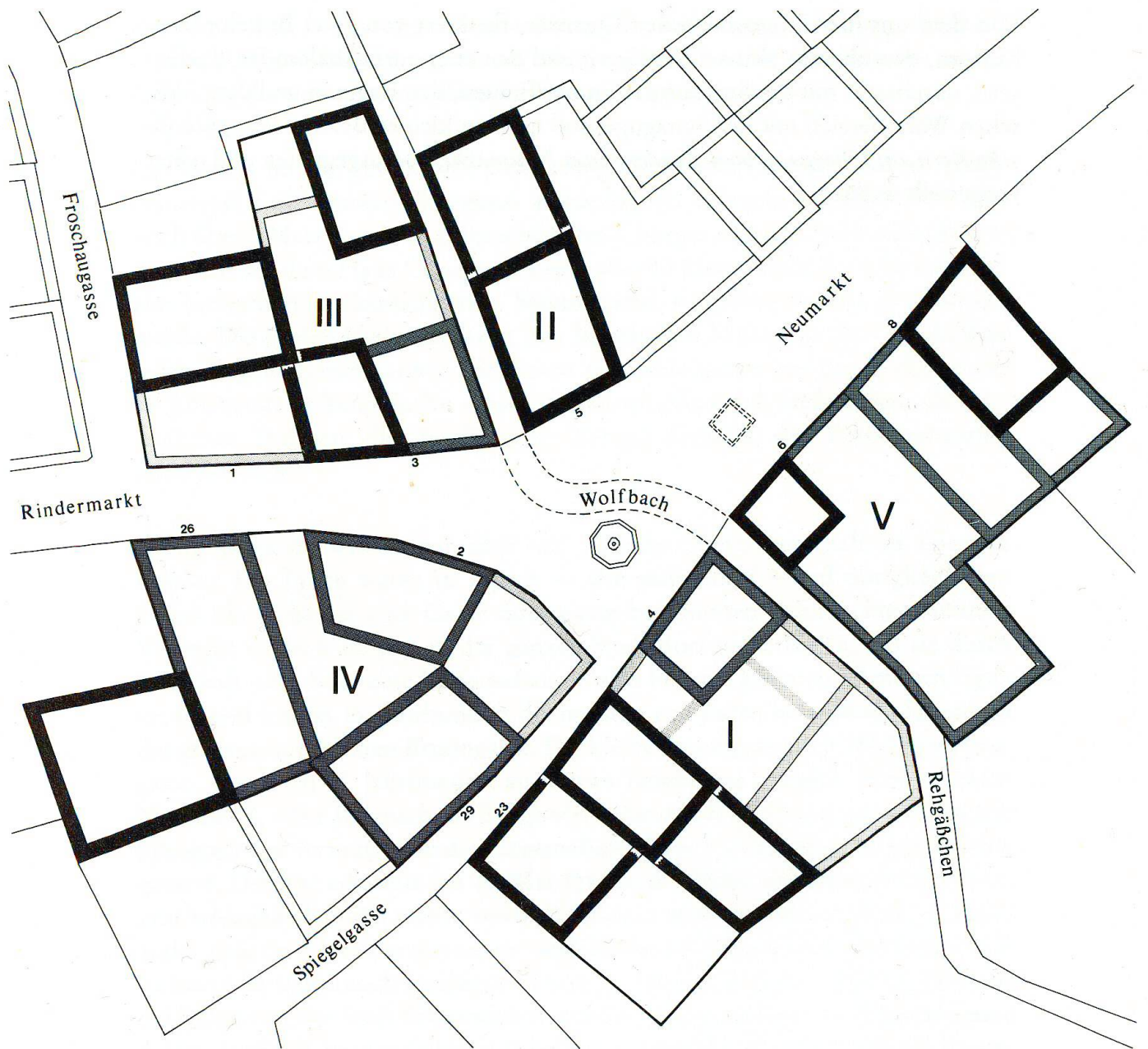
19 Grundrissentwicklung des «höfischen Kerns»: dunkler Raster = Kernbauten der ersten Hälfte des 13. Jahrhunderts; hellerer Raster = Baukörper der zweiten Hälfte des 13. Jahrhunderts; heller Raster = Anbauten 14./15. Jahrhundert.
