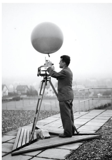
Mit diesem Ballon wurden in den 30er- und 40er-Jahren Höhenwinde gemessen.
