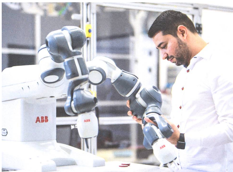
Der kollaborative Roboter YuMi der Firma ABB Semiconductors zvg
