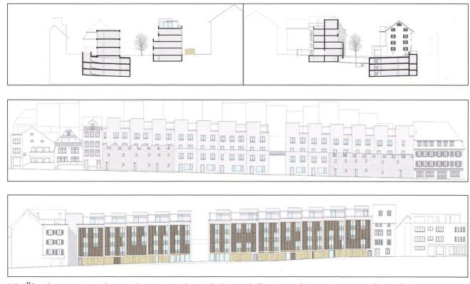
Die Überbauung Sandweg-Eisengasse im Schnitt und die Fassaden zu Promenade und Eisengasse.
