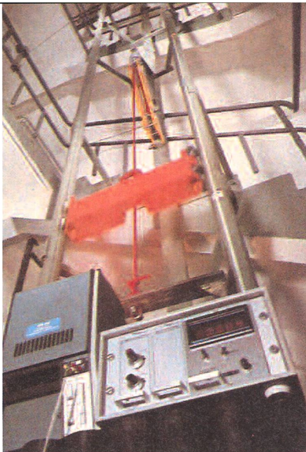
Im Treppenhaus in Lenzburg war eine Sturz-anlage zur Seilprüfung installiert.
