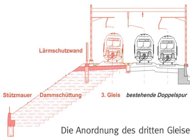
Die Anordnung des dritten Gleises im Bereich des Einschnitts Zeichnung: SBB
