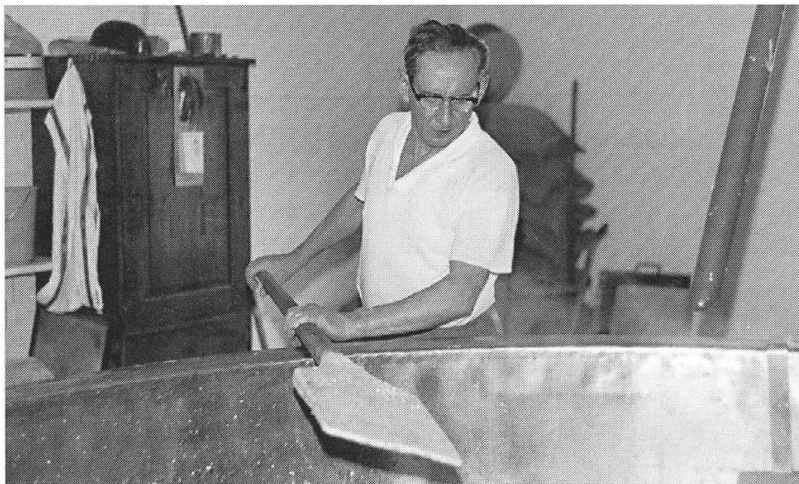
Siedermeister Adolf Roth am Siedekessel II beim Verseifen eines Grundseifen- suds, das «Wehrscheit» in den Händen.
