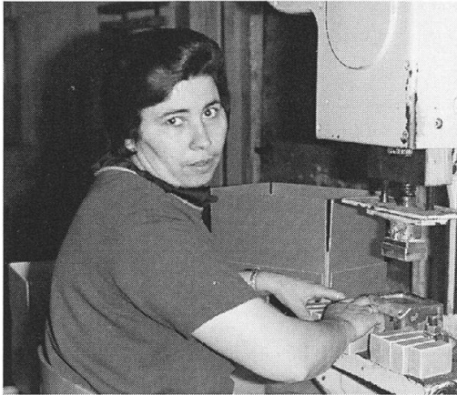
Frau Maria Fracassi beim Pressen von Bimssteinseifen, die nach dem Verfahren der halbwarmen Verseifung gesotten und in Blöcke gegossen wurden.
