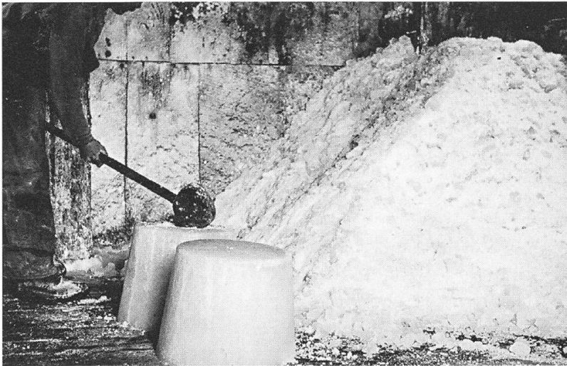
Herstellung von Kristallsoda: die heisse Sodalösung wurde in konischen Kesseln auskristallisiert. Nach dem Stürzen der Kristallisierkessel wurde die Kristallsoda zerkleinert und in 1-kg-Pakete oder 50-kg-Säcke verpackt.
