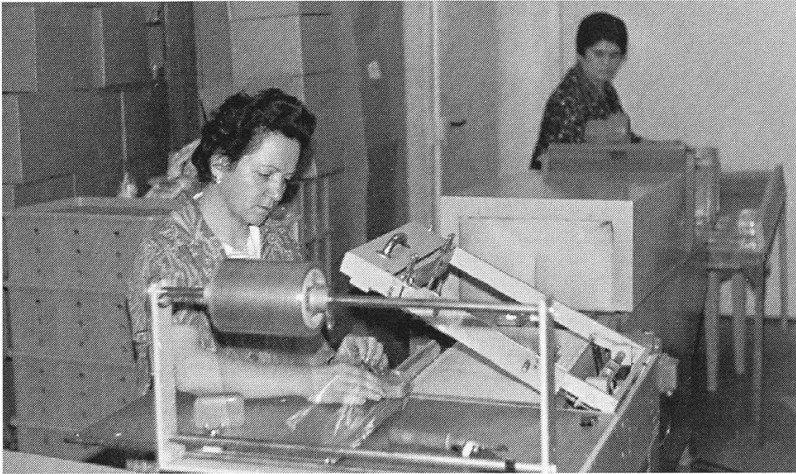
Ende der 60er-Jahre wurde ein Folien-Schrumpftunnel angeschafft. Anna Pelizzo verpackt Toilettenseifen in Schrumpfbeutel.
