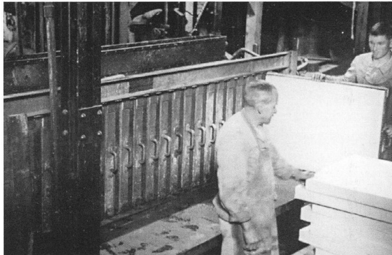
Auspacken der Kühlpresse. Die aus dem Kernseifenkessel abgezogene heiße Seife wird in Platten zu 50 kg gegossen und abgekühlt.
