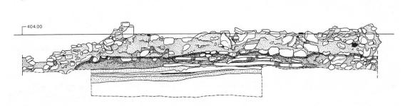
Abb. 8: Die Mörtelmischanlage und die Abwicklung ihres Kragenmauerwerks aus dem 16. Jahrhundert. Zeichnung: Kantonsarchäologie Aargau, Eva Weber. Foto: Kantonsarchäologie Aargau, Theo Frey.
