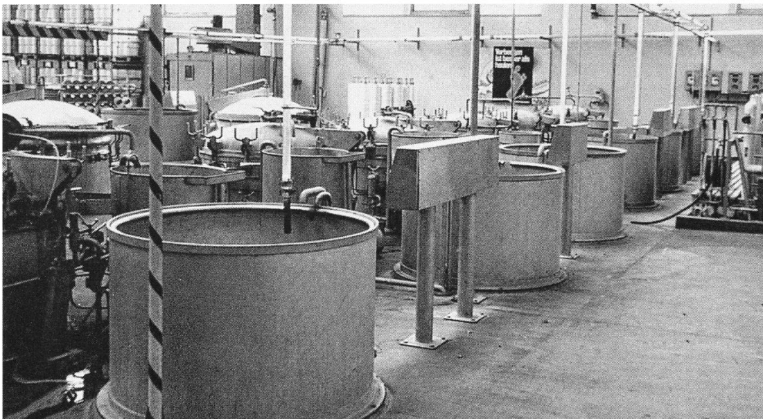
Färberei 1982, Mischbehälter für die Farbstoffe.
