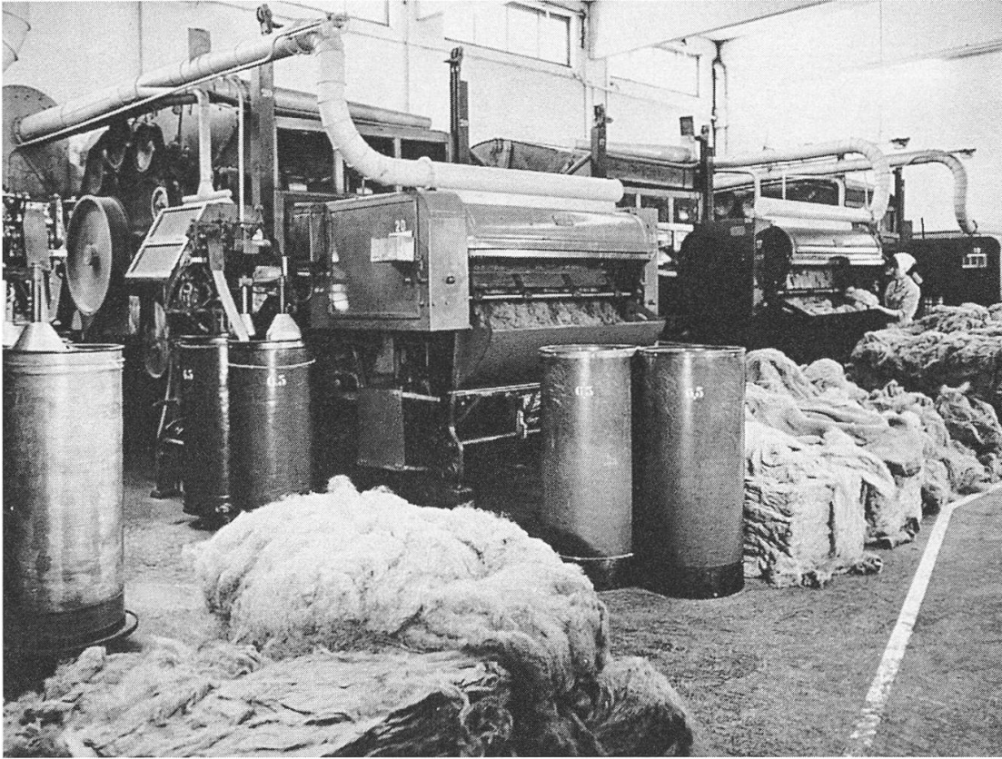
Hechelmaschine in der Hanf- und Flachsspinnerei, 1963.
