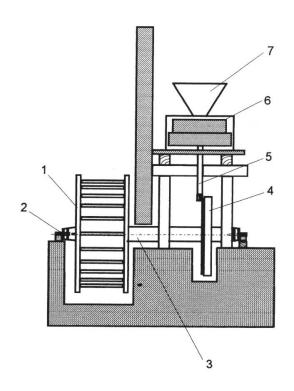
Funktionsprinzip einer Getreidemühle mit Wasserradantrieb
