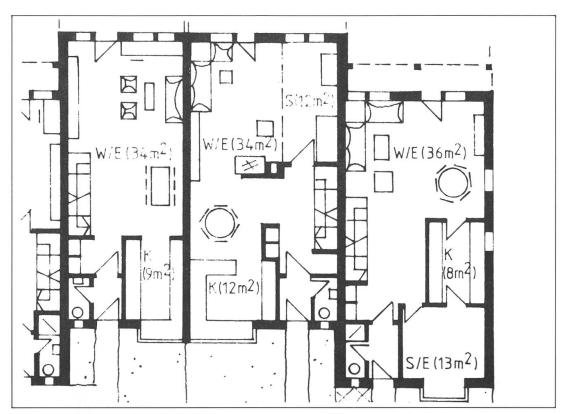
Abb. 16 Grundrisse zu Reihenhaustypen laut Vorprojekt (mit, von links, 120, 153 und 144 m²; Obergeschosse siehe Abb. 17)
