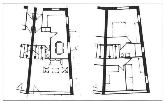
Abb. 7 5-Zimmer-Reihenhaustyp laut Vorprojekt mit 119 m² (halbgeschossig versetzt) (Siehe Abb. 2:④)
