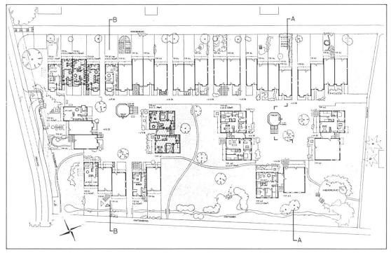
Abb. 13 Grundriß Eingangsgeschoß Vorprojekt 1:200 (Umgebungsgestaltung gilt laut Abb. 12)
