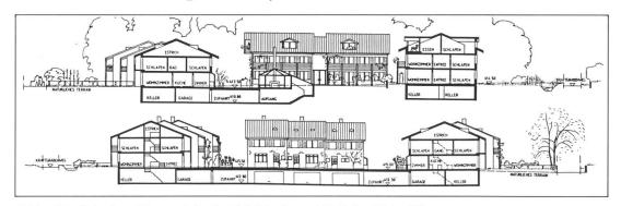
Abb. 15 Schnitte Vorprojekt 1: 200 (A-A und B-B in Abb. 13)
