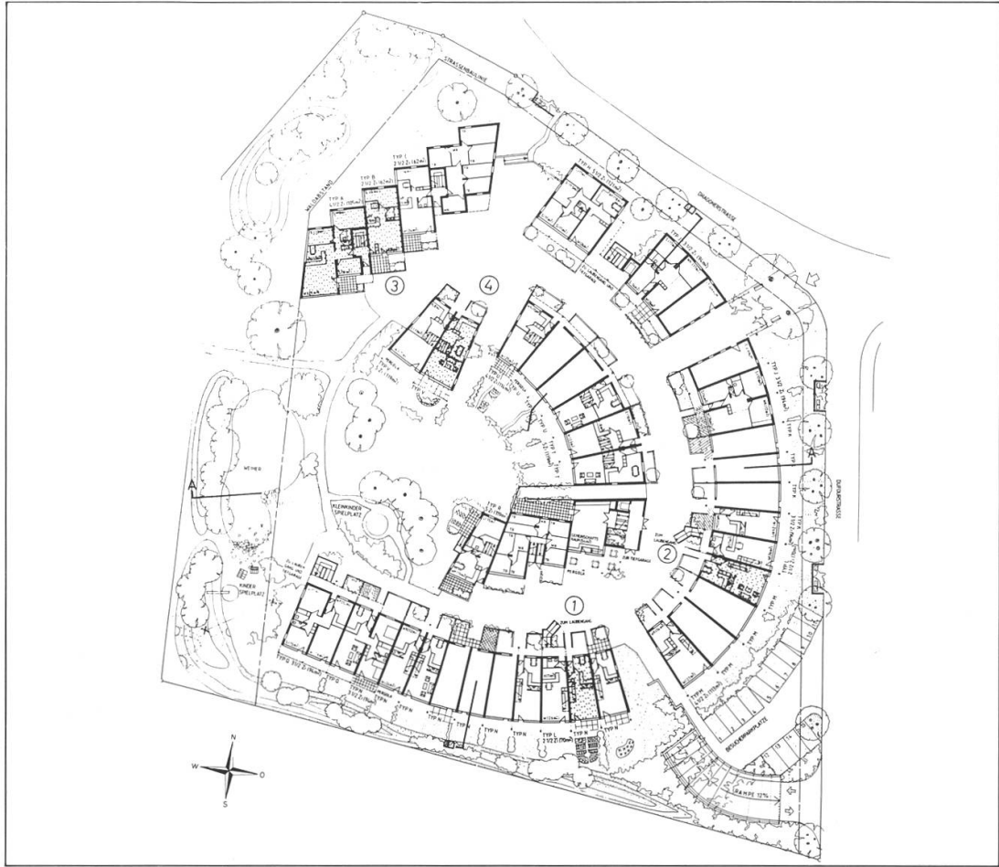
Abb. 2 Grundriß Eingangsgeschoß Vorprojekt 1:200 (Rampenausfahrt gilt laut Abb. 1)
