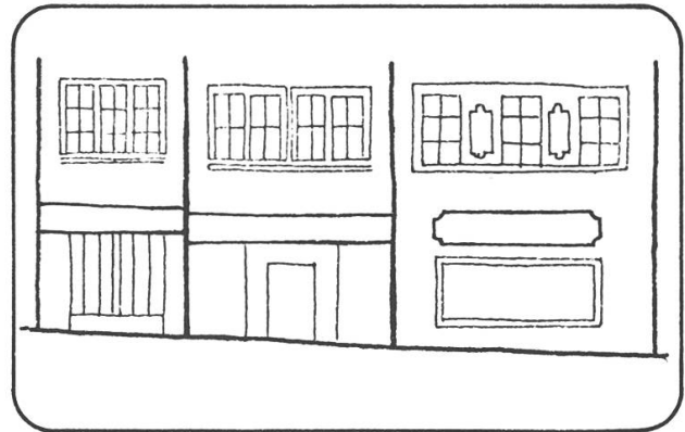
Abb. 127, Sturzbetonung und Zierelement als einzige Ausnahmen
