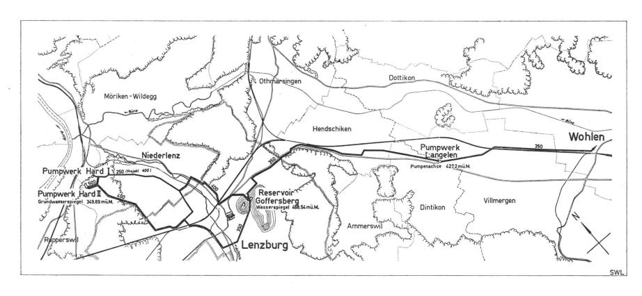
Situationsplan der Pumpwerke, Reservoire und Hauptleitungen der Wasserversorgung Lenzburg
