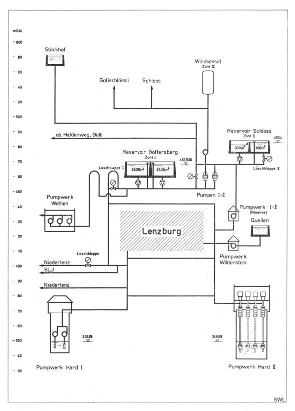
Schematische Darstellung der Pumpwerke, Reservoire und Hauptleitungen der Wasserversorgung Lenzburg
