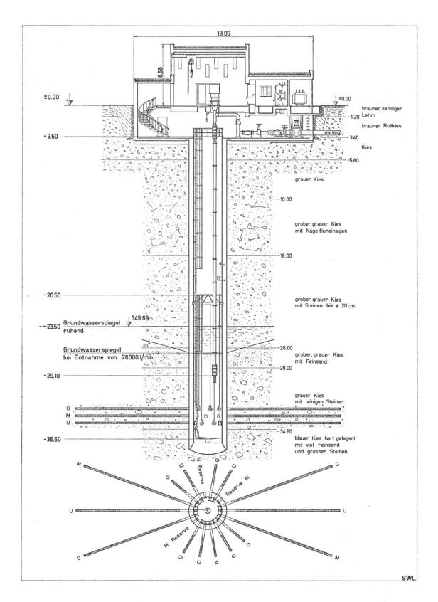
Schnitt durch Pumpwerkgebäude und Fassung
