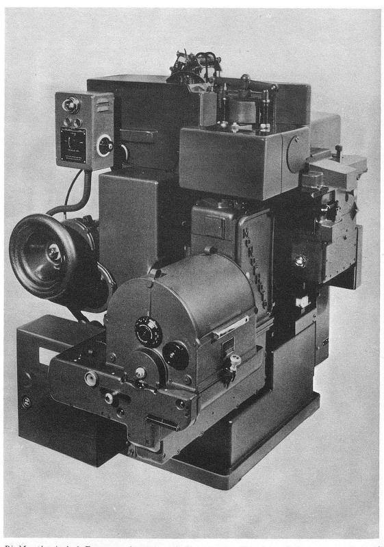
$\label{lem:continuous} Die\ Monophoto\ ist\ das\ in\ Europa\ am\ meisten\ angewandte\ Photosatzsystem.\ Ein\ auf\ einem\ Perforator\ erzeugtes\ Lochband\ steuert\ die\ oben\ abgebildete\ Belichtungsmaschine.$
