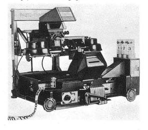
und die in Zusammenarbeit mit Hollenstein (Paris) entwickelte französische *Phototitreuse ABM*, die beweglicher ist, weil mit transparenten Filmmatrizen gearbeitet werden kann; diese lassen Verfeinerungen des Satzbildeszu, während beim Hadego-Gerätstarre Plastikbuchstaben Verwendung finden, die wie Bleibuchstaben gesetzt und abgelegt werden müssen, die aber auch keine Willkür des Setzers zulassen.
