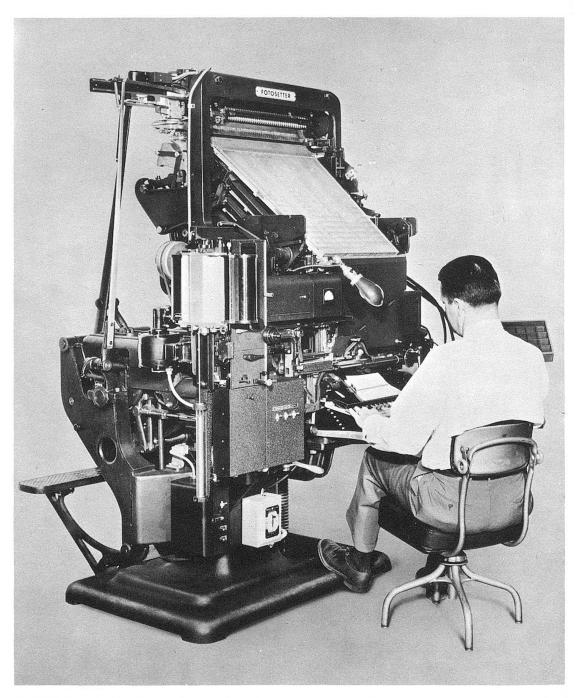
der Bleisetzmaschine heraus entwickelt, bietet der Fotosetter dem bedienenden Personal die leichte Möglichkeit der Umschulung. Die Maschine hat einen Matrizenumlauf ähnlich der Bleisetzmaschine. Die Leistung hängt, sofern zum Betrieb nicht getastete Lochstreifen verwendet werden (was bei den neuen Modellen möglich ist und was eine höhere
