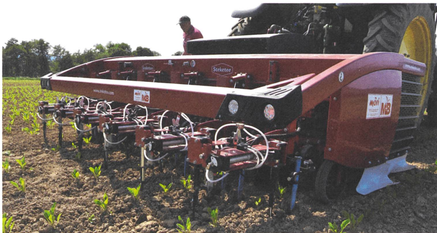
Hackroboter wie der Steketee funktionieren in gesetzten Reihenkulturen wie Kohl, aber momentan nicht in gesäten Kulturen wie Zuckerrüben.
