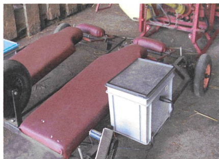
Das elektrisch angetriebene Jätvelo ist leicht gebaut.
