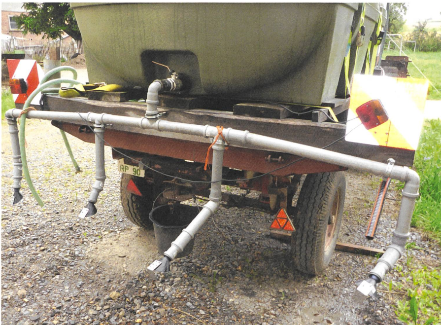
Das Wasser läuft von allein durch die vier in 75 cm Abstand angebrachten Rohre. Die Aufsätze mit Metallwinkeln sorgen für eine Versprenkelung.
