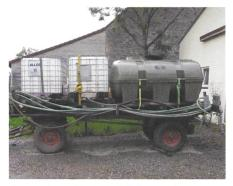
Zwei gebrauchte 1m³-Behälter und ein neuer 3m³-Behälter sind auf dem Anhänger gut befestigt und bieten mehrere Wasserentnahmemöglichkeiten.
