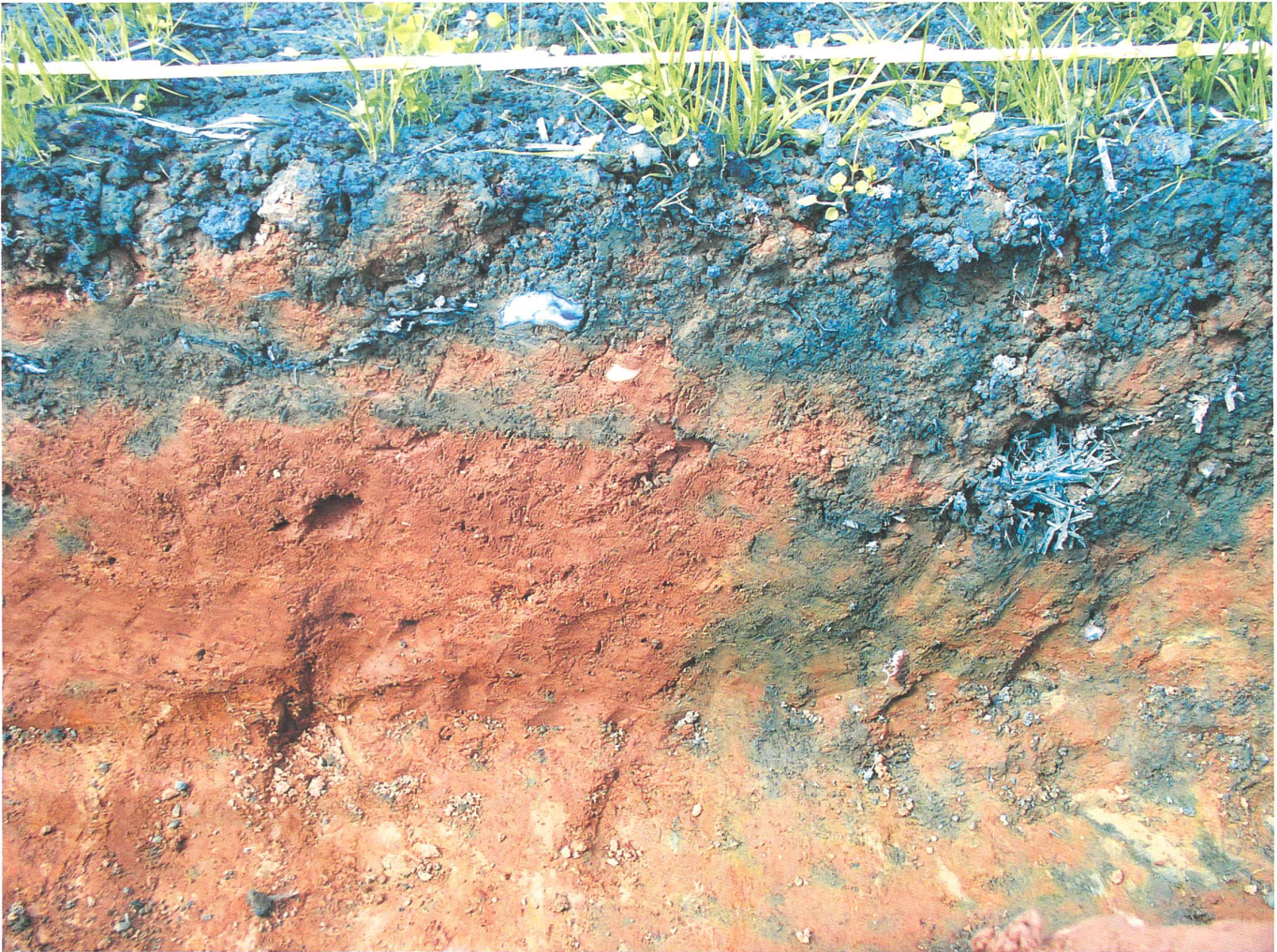
Für Workshop-Organisator Fredi Strasser ein Augenöffner des Tages: Rechts sickert das gefärbte Wasser viel tiefer in den Reckenholzboden. Dort wurde mit einem Onland-Pflug zu Acker gefahren. Links mit dem normalen Pflug. Die Folge: Verdichtung.
