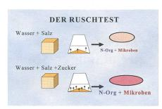
Schematischer Ablauf der Rusch-Probe.
