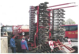
Sämaschine im EU-Format mit neun Meter Arbeitsbreite.
