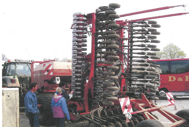
Sämaschine im EU-Format mit neun Meter Arbeitsbreite.
