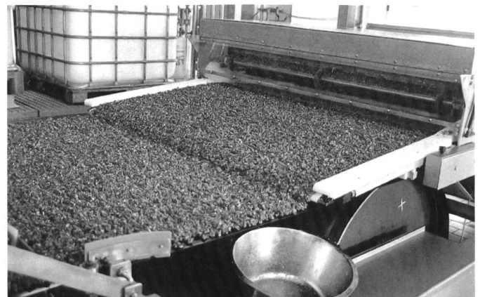
Ausstoss 2000 kg Knuspermüesli pro Stunde im Dreischichtbetrieb
