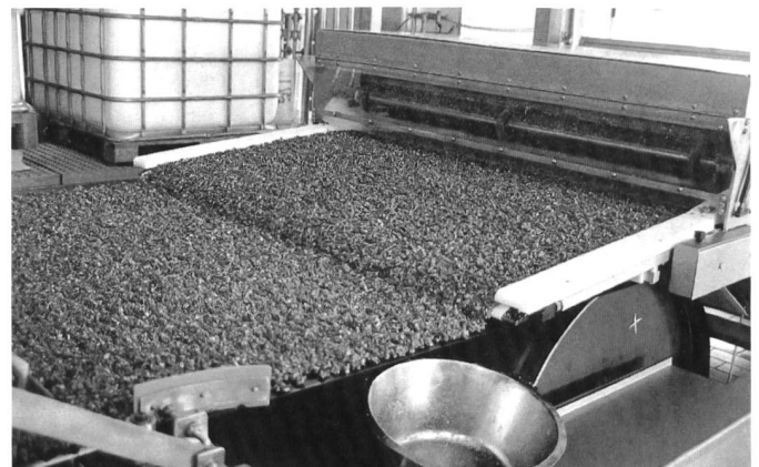
Ausstoss 2000 kg Knuspermüesli pro Stunde im Dreischichtbetrieb
