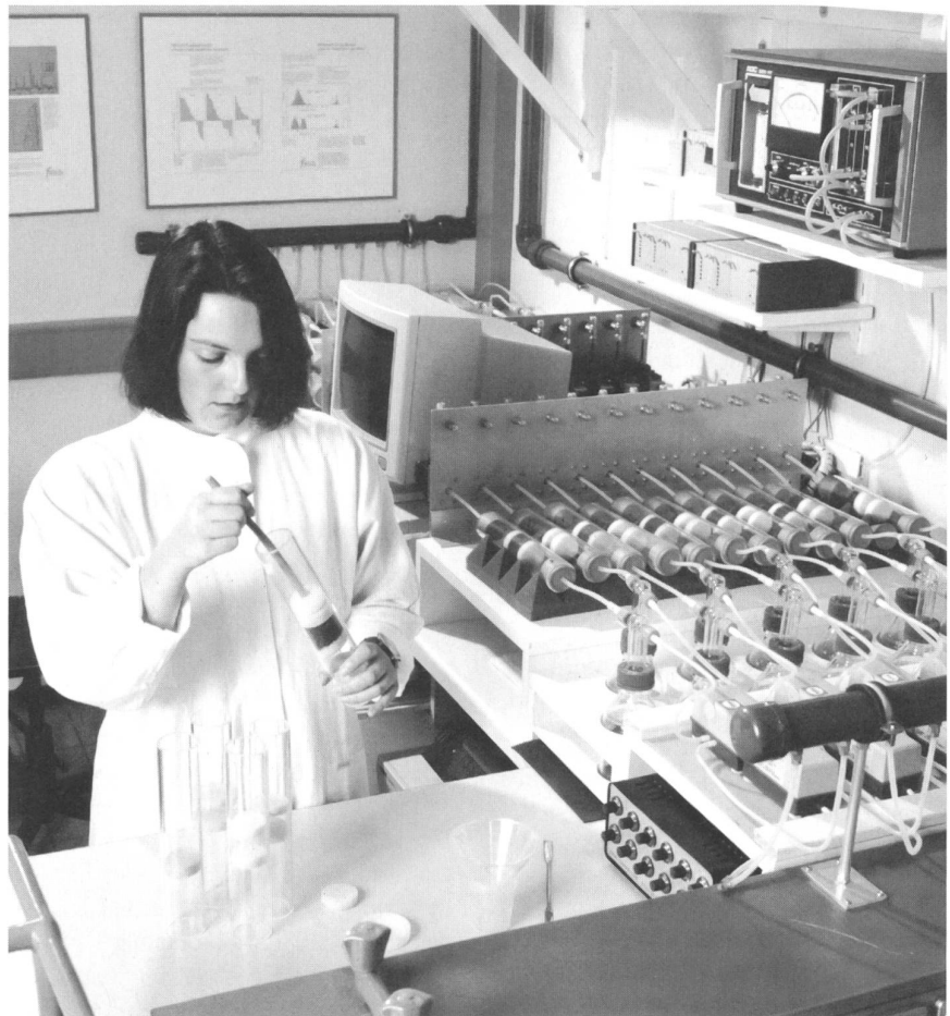
Messplatz für die SIR-Anlage in Herborn – computergesteuerte Durchflussmessung in einer Heinemeyer-Anlage
