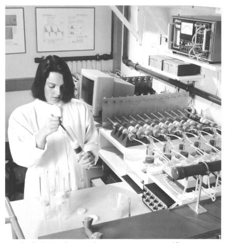
Messplatz für die SIR-Anlage in Herborn – computergesteuerte Durchflussmessung in einer Heinemeyer-Anlage
