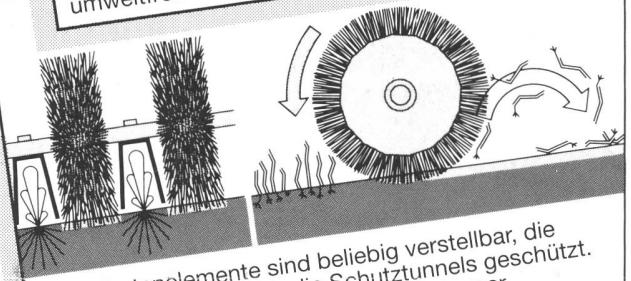
Die Bürstenelemente sind beliebig verstellbar, die Pflanzen werden durch die Schutztunnels geschützt.
