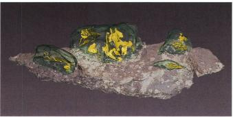
Abb. 11 | Lesender Pfarrer (1. Fassung, Kat. 1146), Synchrotron-Röntgen-Mikrotomografie (SRXTM) derselben Probe wie Abb. 10. In der Darstellung ist das noch intakte Messing (gelb eingefärbt) im Inneren der grünen Klümpchen erkennbar.
