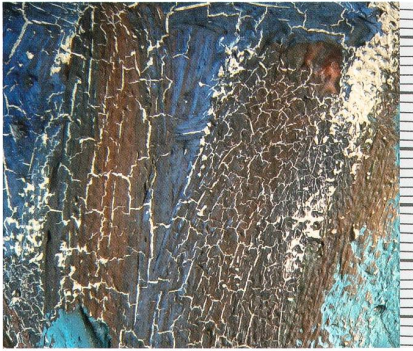
Abb. 14 | Bauerngarten , 1908, Ölfarbe auf Gewebe, 98,5 × 91,5 cm, Kunstmuseum Solothurn (Kat. 1908.24), Detail (ca. 3,5 × 4 cm) von rechts unten, im Kleid der Figur im Vordergrund. An diesem Gemälde wurde eine von Amiet selbst applizierte bleiweisshaltige Ölgrundierung festgestellt. Offenbar hat er den Grund nicht ausreichend trocknen lassen, bevor er ihn verwendete, denn die Farbschicht ist an vielen Stellen von feinen Fröhschwindrissen durchzogen.
