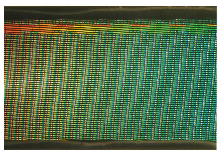
Sichtbarmachung der einzelnen Spuren mittels Ferrofluid: Die Synchronpulse und die Felder der aufgenommenen Grautreppe können identifiziert werden, Foto: Johannes Gfeller
