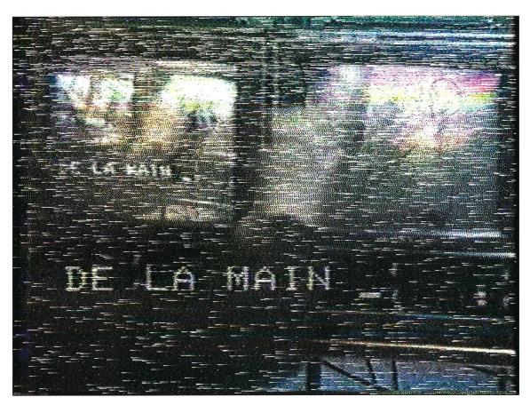
Zunächst setzt sich ein Kopf zu, das bewegte Bild ist noch schemenhaft zu erkennen, aber jede zweite Zeile ist verrauscht. Nach 37 Sekunden setzt sich auch der zweite Kopf zu, und das Bild fällt komplett aus.
