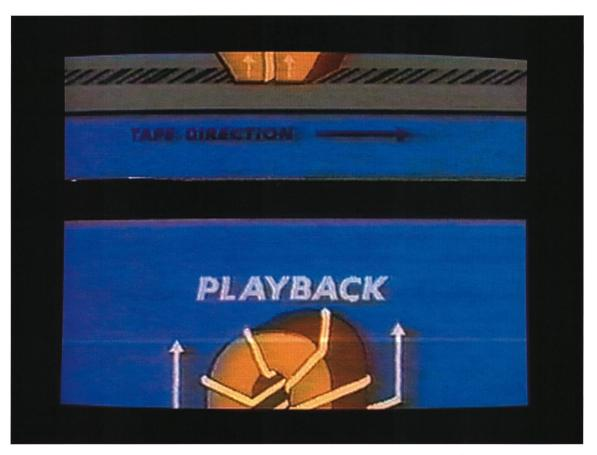
Hier führt die Stellung des Bildfang-Reglers (Drehrichtung nach rechts = freilaufende Bildwechselfrequenz zu hoch) zum vertikalen Bilddurchlauf.
