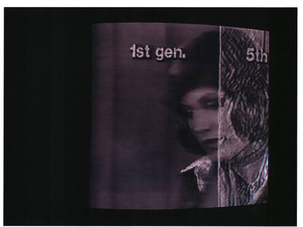
Durch Betätigung des Zeilenfang-Reglers am Sichtgerät kann das Bild soweit horizontal verschoben und/oder verzerrt werden, bis es zusammenbricht. Hier ist zusätzlich die Farbe ausgefallen. Der Ton wird nicht beeinträchtigt.
