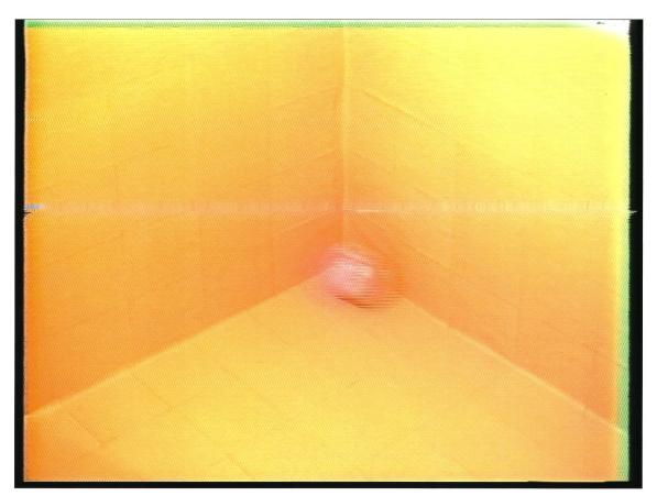
Der einzelne Kratzer verläuft in Längsrichtung des Bandes, folglich steht der Störstreifen anhaltend auf gleicher Bildhöhe. Kratzer zeigen sich in der Regel feiner und schärfer umrissen als >Knicke und zerknittertes Band.
