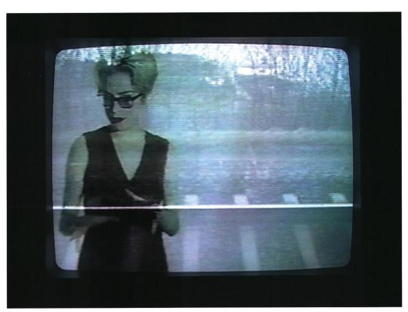
Die ersten 17 Sekunden zeigen dieses PAL-Band im korrekten Wiedergabemodus (Videostill), dann folgt die gestörte Wiedergabe mit dem **Multinorm-Abspielgerät** in NTSC-Einstellung. Das Band wird zu schnell wiedergegeben: das Bild ist bis zur Unkenntlichkeit gestört und die Tonlage ist zu hoch.
