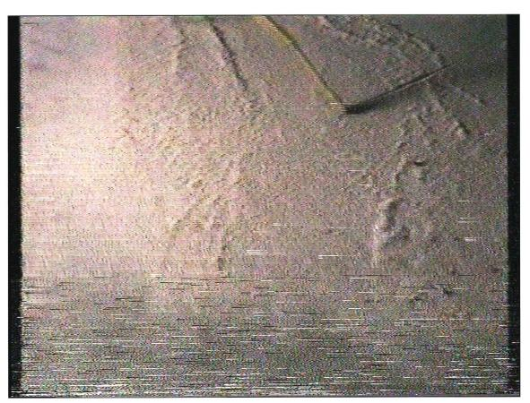
Ein erstes sichtbares Anzeichen für einen Tracking-Fehler kann bereits eine leichte Unruhe in der Bildstruktur sein, bei einem ausgeprägten Tracking-Fehler verrauscht das Bild. Zusätzlich können die Zeilen horizontal ausreissen.
