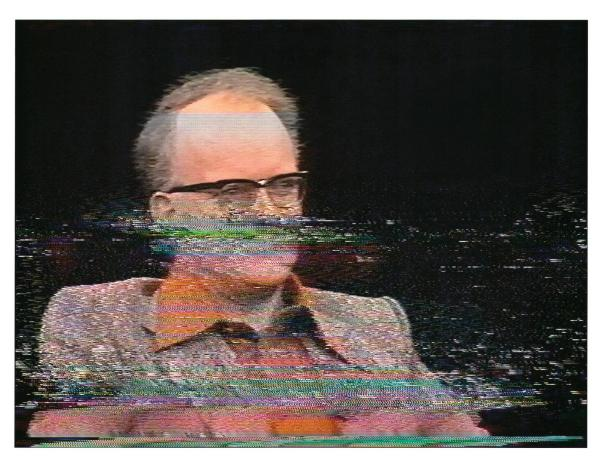
Hier lässt sich die Störzone durch Betätigung des manuellen Tracking-Reglers teilen und wieder zusammenführen, aber nie ganz von der Bildfläche eliminieren. Dies ist ein Indiz für einen sog. Curvature Error, d. h. eine kurvige Deformation des Bandes.
