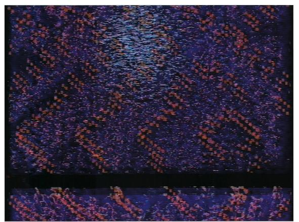
Das gesamte Bild schwankt unregelmässig in der Horizontalen. Gut hörbar sind die Tonhöhenunterschiede durch die Beschleunigung bzw. Abbremsung des Bandvorschubs bzw. der Kopfrotation. Wenn die **Wiedergabeköpfe** dabei die Spuren verfehlen, so kommt es zu verrauschten Bildstrukturen und zu einem Durchfallen das Bildes.
