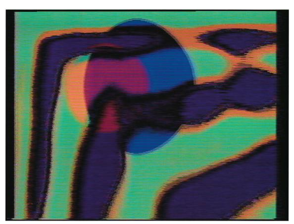
In den ersten 15 Sekunden wird dieses PAL-Band korrekt wiedergegeben, anschliessend zeigt sich der Jalousie-Effekt. Dabei bilden zwei Zeilen optisch ein Paar. Ihre Farbwerte weichen von den ursprünglichen Farben in entgegengesetzte Richtungen ab. Die Zeilenpaare wirken wie Streifen, die stehen oder langsam vertikal über den Bildschirm wandern.
