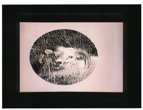
Die ersten 8 Sekunden zeigen dieses NTSC-Band im korrekten Wiedergabemodus. Dann folgt die gestörte Wiedergabe auf einem Multinorm-Abspielgerät bei korrekter NTSC-Einstellung, aber mit einem Monitor in PAL-Einstellung (Videostill). Die Farbe fällt aus, das Bild wird vertikal gestaucht.
