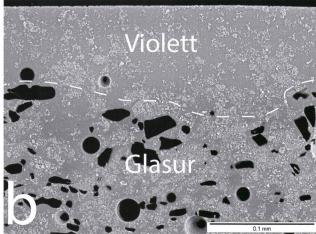
Abb. 19: Querschnitte durch die Scharffeuerfarbe Violett (Ofe 24). (a) Im Auflicht (Dunkelfeld); (b) Derselbe Ausschnitt als REM-RSE Bild. Fotos M. Maggetti.
