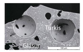
Abb. 18: Querschnitt durch die Scharffeuerfarbe Türkis (Ofe 23). Der türkisfarbene Pinselstrich (oberhalb der weissen gestrichelten Linie) enthält in fast homogener Verteilung einzelne Cassiterite und -Haufen und unterscheidet sich von der darunterliegenden Weissglasur nur durch die fehlenden grossen Quarze. Fotos M. Maggetti.
