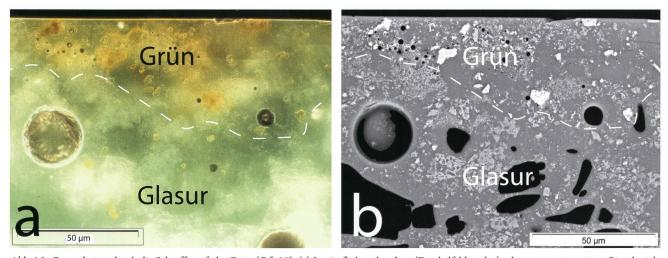
Abb. 16: Querschnitte durch die Scharffeuerfarbe Grün (Ofe 27). (a) Im Auflichtmikroskop (Dunkelfeldmodus) erkennt man im grünen Pinselstrich gut die gelben bis roten Glaskörner in einer grünlichen, glasigen Grundmasse; (b) Derselbe Ausschnitt als REM-RSE Bild. Fotos M. Maggetti.
