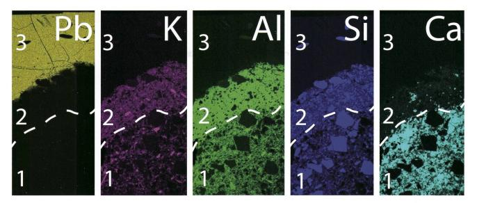
Abb. 9: REM-EDS Verteilungskarten für die Elemente Blei (Pb), Kalium (K), Aluminium (Al), Silizium (Si) und Kalzium (Ca) eines Querschnittes der Probe Ofe 20. (1) Scherbenkörper, (2) weisse Engobe und (3) Glasur. Für diese Bilder gilt: Je heller die Farbe, desto höher ist der Anteil des betreffenden Elementes für den betrachteten Bereich. Bildbreite je 0.46 mm. Fotos M. Maggetti.
