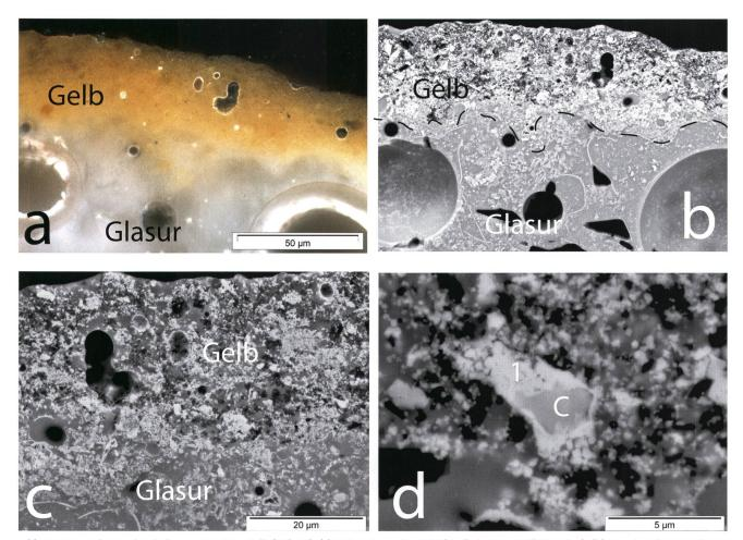
Abb. 15: Querschnitte durch den zweiten Typ Gelb (Ofe 21). (a) Mikroskopisches Bild (Auflicht, Dunkelfeldmodus); (b) Fast derselbe Ausschnitt als REM-RSE Bild (Gleicher Massstab wie a); (c) Nahaufnahme, BSE-RSE Bild; (d) Cassiteritkern (C) in einem grossen Pb-Sb-Sn-Kristallaggregat. Die kleinen weissen Kristalle sind entweder Pb-Sb-Oxyde oder Pb-Sb-Sn-Oxyde (1 = Analyse Ofe 21b-2 in Tab. 6). Grau = glasige Matrix, schwarz = SiO2-Phase (Cristobalit ?). BSE-RSE Bild. Fotos M. Maggetti.
