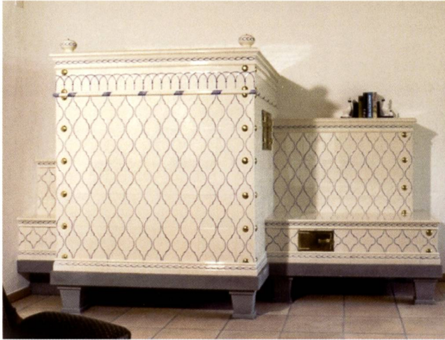
Abb.51: Schreiber Keramik AG Matzingen. Traditioneller Kachelofen nach Bleiker Vorbild, Unterglasurmalerei auf hochweisser Behautmasse, transparent glasiert (FA). Foto Hansjörg Küenzi.
