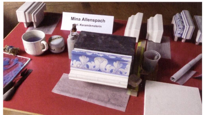
Abb. 58 Schreiber Keramik AG. Kartause Ittingen. Wissenswerkstatt 2010, Malvorführungen von Mina Allenspach-Egloff. Untergrasurmalerei auf hochweisses, geschliffenes Kranzgesims (FA). Foto J. B. Schreiber.
