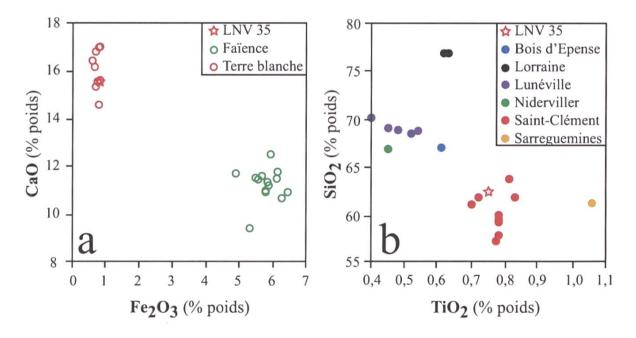
Fig. 2: (a) Position de l'analyse LNV 35 dans le diagramme binaire CaO-Fe<sub>2</sub>O<sub>3</sub> séparant parfaitement les faïences (14 analyses) et les terres blanches (9 analyses) de la manufacture de Saint-Clément; (b) Diagramme binaire SiO<sub>2</sub>-TiO<sub>2</sub> de terres blanches calcarifères («calcaires», respectivement riches en CaO) de plusieurs manufactures lorraines et du Bois d'Épense.<sup>22</sup> Lorraine = manufacture lorraine inconnue. *Dessins Marino Maggetti*.
