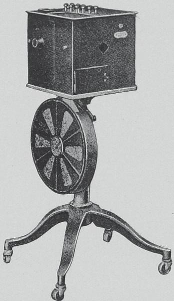
Die Billet-Druckmaschine „National“ ist hervorgegangen aus dem dringenden Bedürfnis nach einer Maschine, welche die Selbsterstellung von Billets und die Sicherung der aus dem Verkauf dieser Billets vereinnahmten Beträge ermöglicht.
