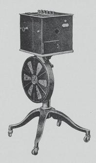
Die Billet-Druckmaschine "National" ist hervorgegangen aus dem dringenden Bedürfnis nach einer Maschine, welche die Selbstherstellung von Billets und die Sicherung der aus dem Verkauf dieser Billets vereinnahmten Beträge ermöglicht.
